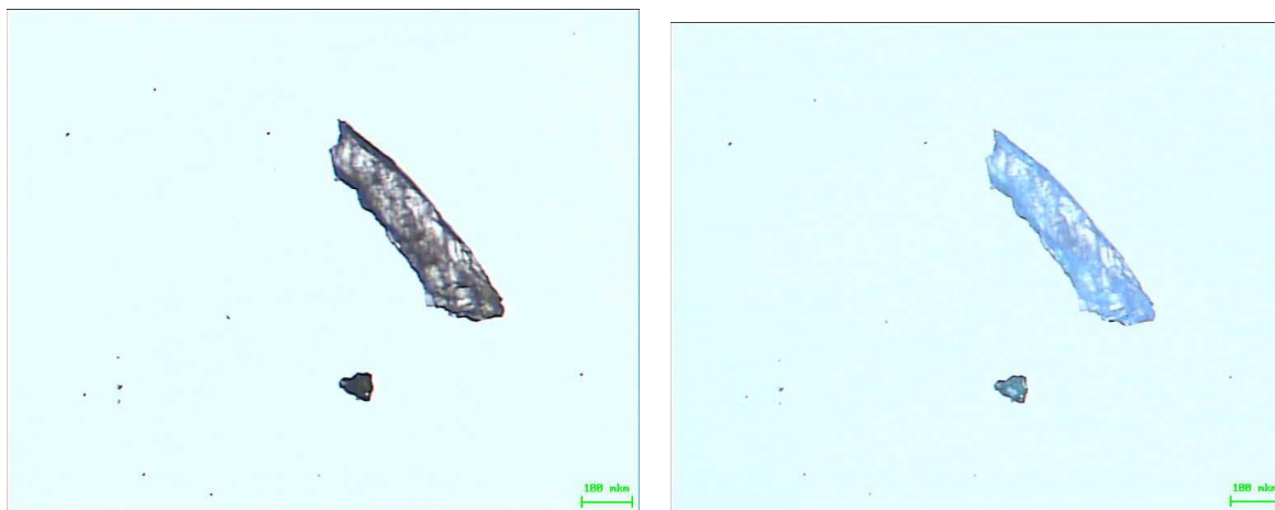
Рис. 2.9.1 - Порівняння загального вигляду частинок зв'язки та гірської породи під об'єктивом приладу DialInspect, OSM: чорні частинки–фрагменти матеріалу зв'язки.
