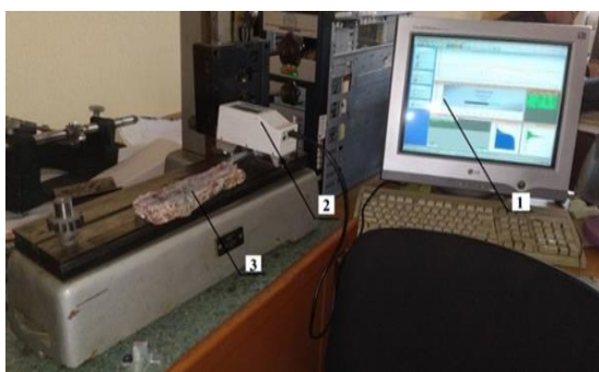
Рисунок 2.6.1 – Стенд для вимірювання шорсткості поверхні: 1-дисплей ПК; 2 – профілометр RT-10 Plus; 3 – зразок.
